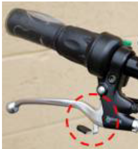
Parkbremse Vorderrad gelöst
